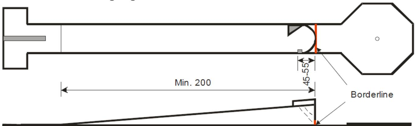
Alternative: Das Zielfeld kann auch in einem 90° Winkel zur Bahn angeordnet werden, wobei sich das Loch in der Steigung auf der gegenüberliegenden Seite des Zielfeldes befinden muss.
